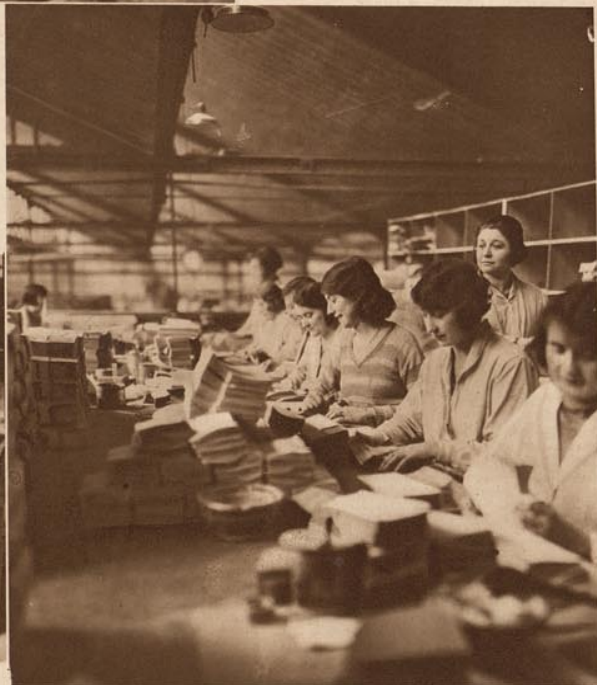
Dans la manufacture d'enveloppes, le pliage à main subsiste. (Usine Blancan.)
